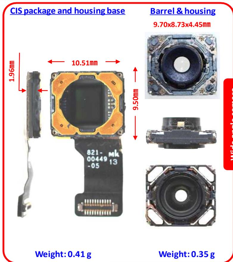
iPhone 7 Plus 2眼カメラの撮影効果・撮映機能の解説をはじめとし、X線をも駆使した分解画像・断面画像を掲載し、レンズユニット構成やOIS・VCM構造を詳らかにしている。また、iPhone 6sシリーズカメラの断面画像と揃え、その比較を公開している。
